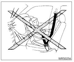
CHILD RESTRAINT INSTALLATION ON FRONT PASSENGER SEAT
