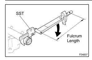
(d) Using SST, torque the stopper.
