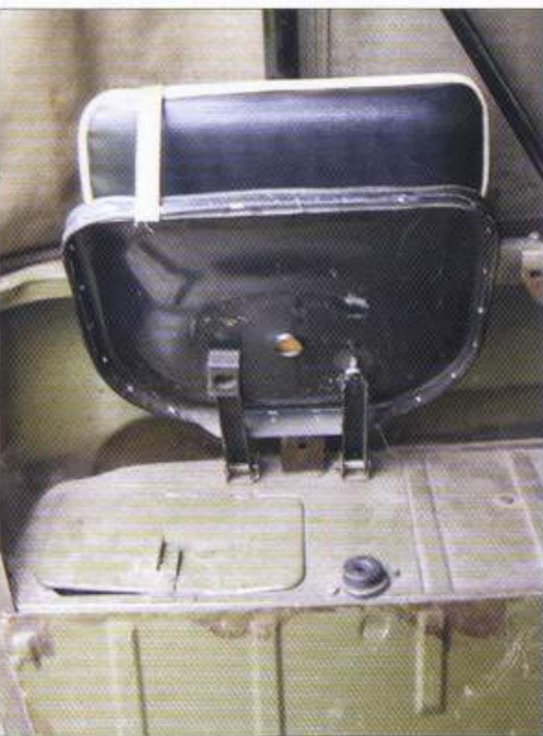
Details of the internal structure of the rear body, the body floor and rear seats. Side seats in open and closed position • Detale tyłu pojazdu, tylne siedziska. Boczne siedziska rozłożone i złożone
