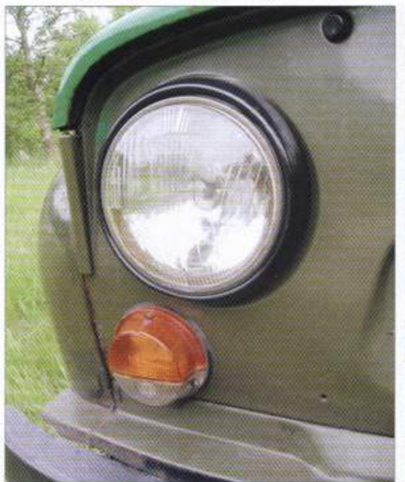
Headlights (type FG122-BES) and indicator lights • Reflektory typu FG122-BES i kierunkowskazy
