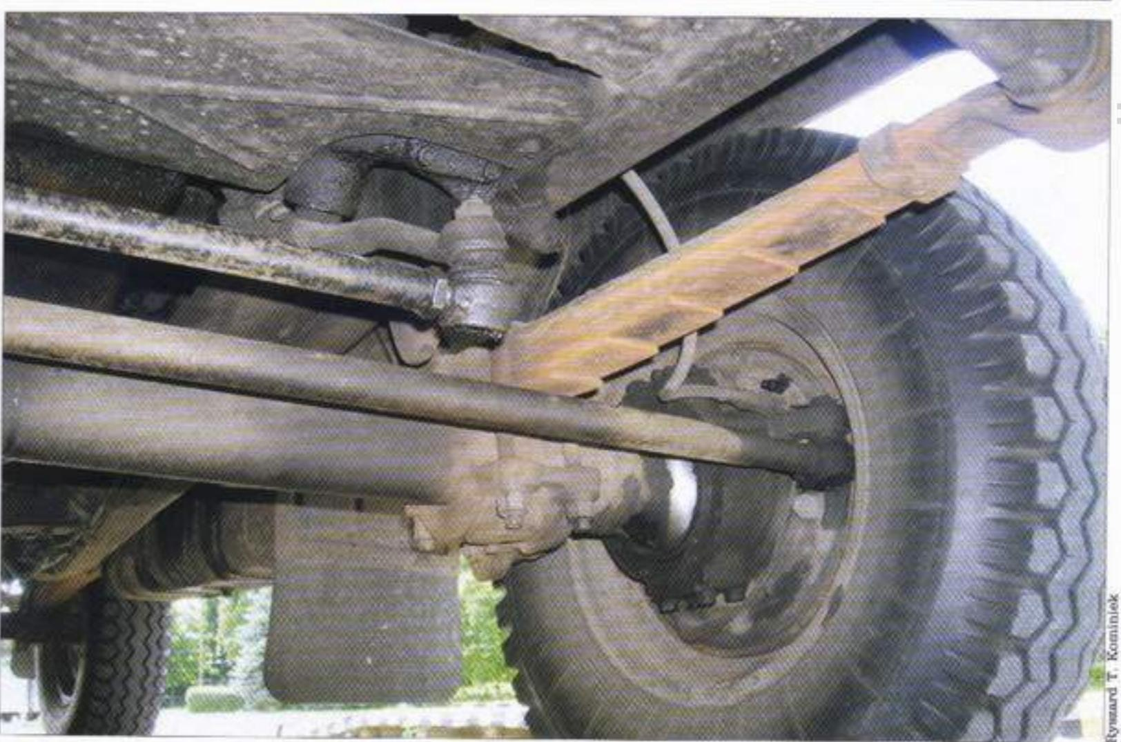
Suspension; longitudinal half elliptical leaf spring, front axle with torque transmission to the front pair of driven wheels • Zawieszenie, wzdłużny, półeliptyczny resor piórowy, przednia oś z przeniesieniem napędu na przednie koła
