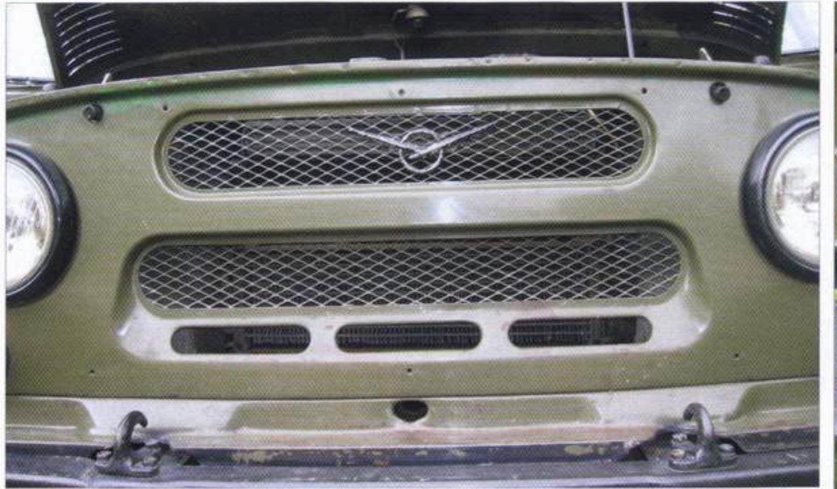
Mesh radiator cover. The emblem of the "UAZ" is clearly visible • Siatkowa osłona chłodnicy ze znakiem firmowym
