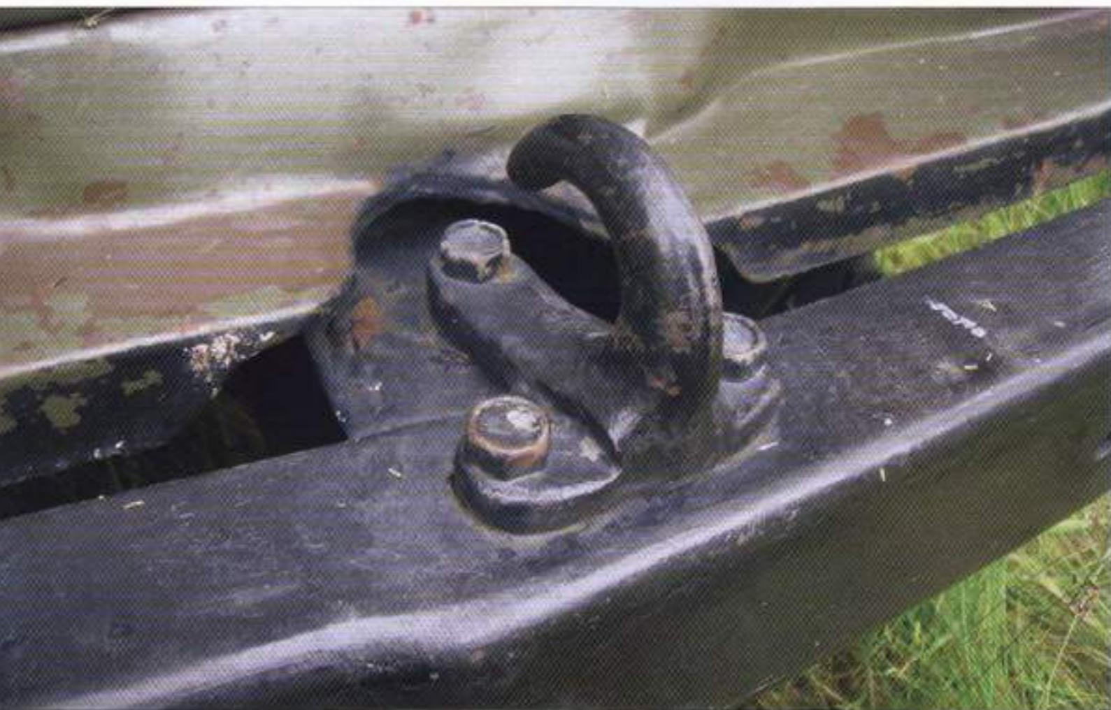
Towing hook on the front bumper • Haki holownicze na przednim zderzaku
