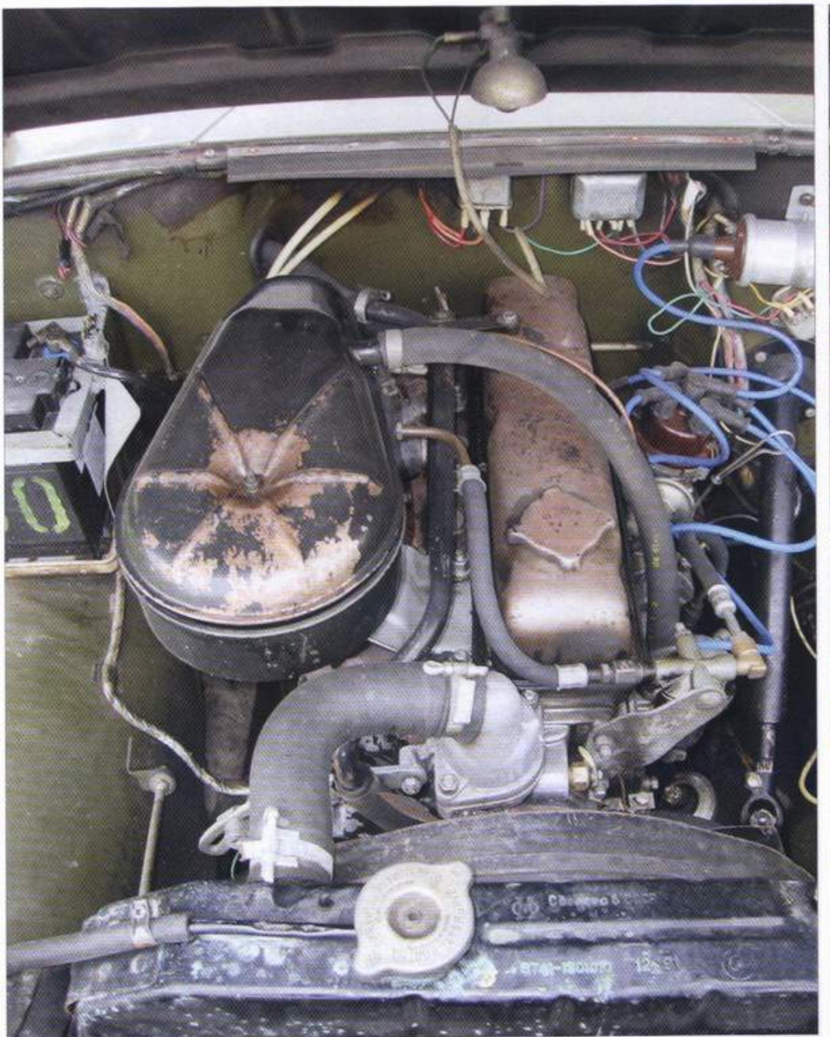
Air filter, radiator and accumulator 6-ST-54EM, 12V, 54Ah • Silnik, filtr powietrza, chłodnica i akumulator
