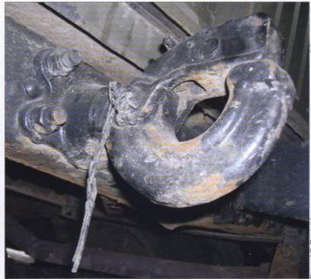
Details of the rear semi-bumpers/footrests. Towing hook. Towing device was destined for maximum load of 850 kg. Electric socket of trailer • Detaile tyłu UAZa: tylny zderzak, hak holowniczy przeznaczony do ciągnięcia przyczepy o maksymalnej masie 850 kg. Gniazdo stykowe przyczepy
