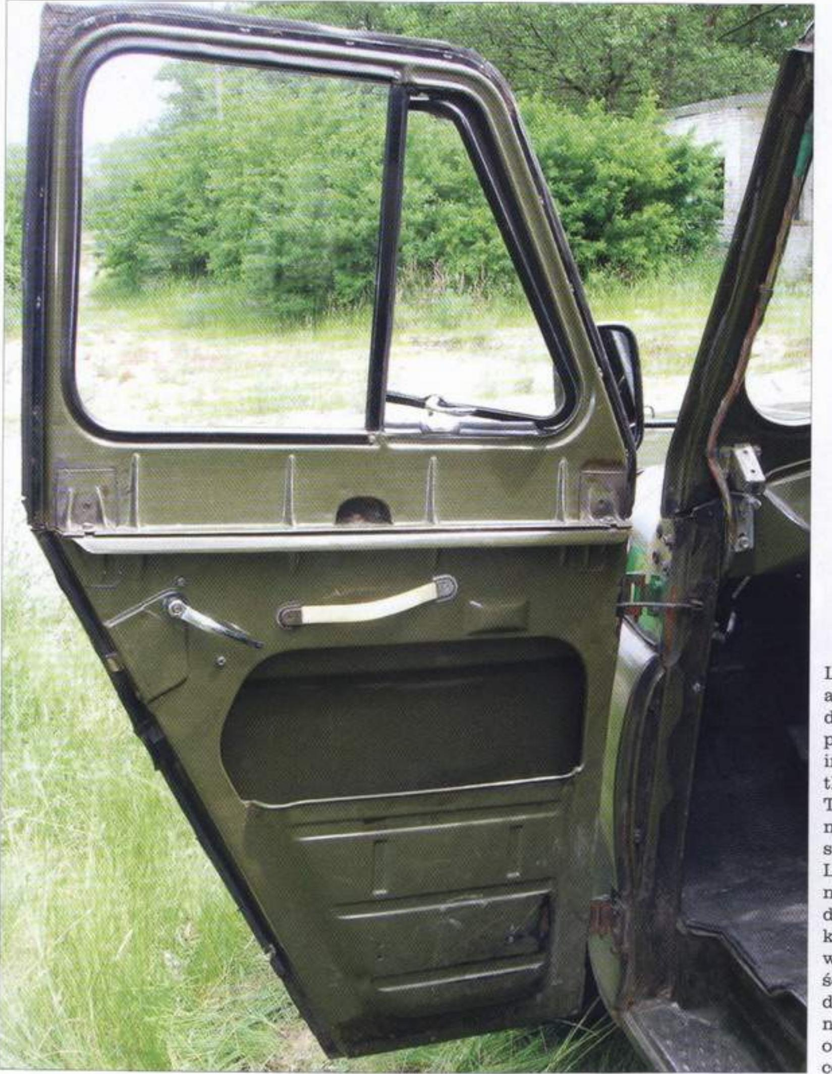
Left front and rear door. The pockets on inner side of the door. The door is not upholstered • Lewe przednie i tylne drzwi. Skrytki na wewnętrznych ściankach drzwi. Drzwi nie były obite tapicerką
