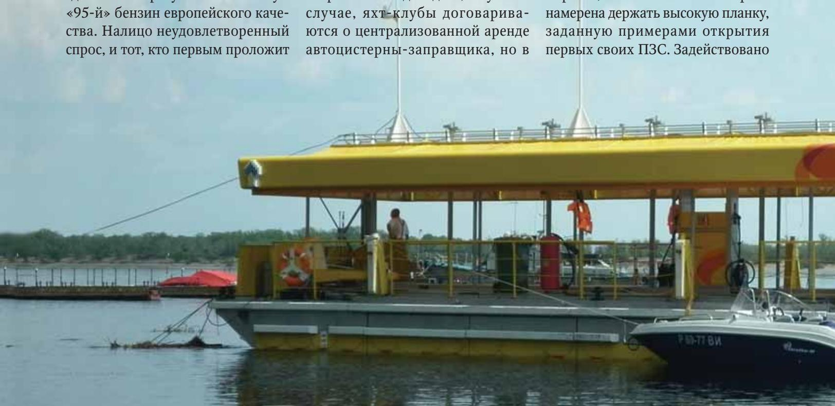
специальное оборудование, чье назначение – безопасная перекачка топлива в судовые емкости и предотвращение возможных его разливов, вплоть до незамедлительной постановки боновых ограждений вокруг с помощью вспомогательного катера.
