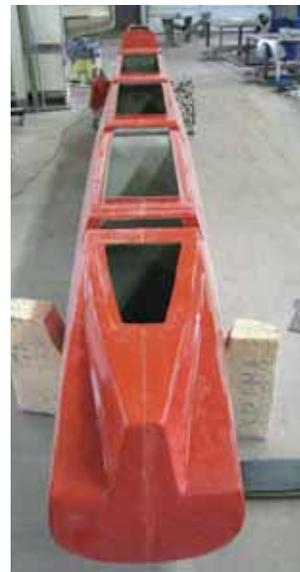
Поплавок разделен на 6 отсеков
