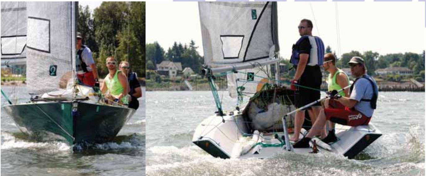
них помещений, гоночную, и в то же время – бюджетную. Конструктор хотел совместить узкий корпус, обладающий высоким скоростным потенциалом, с широкой палубой, что подвело его к применению форм «шарпи» в корпусе – использованию остроскулых обводов. Кроме того, лодку с «гранеными» обводами проще строить.
