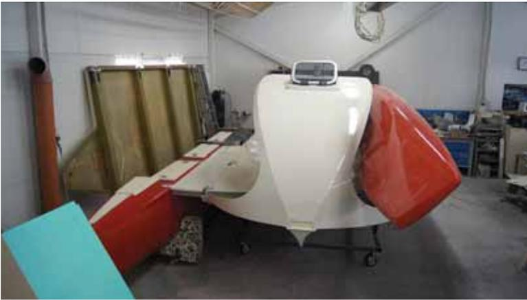
Поплавок катамарана в сложенном состоянии
