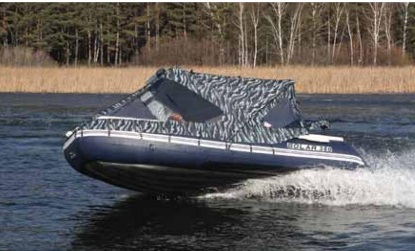
Под обычной «пятнашкой» Solar 380 развил рекордные 44.5 км/ч. Вдвое более мощный же мотор с водометной насадкой не дал преимуществ ни в скорости, ни в грузоподъемности – у него другие задачи
