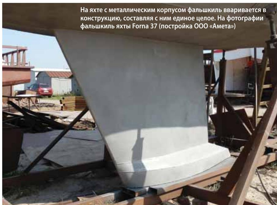
На яхте с металлическим корпусом фальшкиль вваривается в конструкцию, составляя с ним единое целое. На фотографии фальшкиль яхты Forna 37 (постройка ООО «Амета»)
